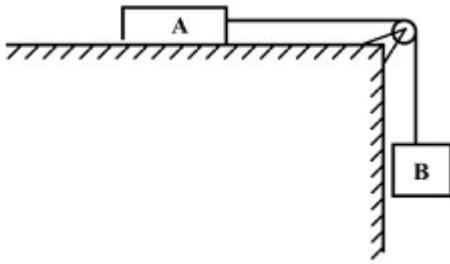
A figura precedente representa dois blocos A e B com massas iguais a 6 kg e 4 kg, respectivamente, inicialmente em repouso e ligados por um fio ideal. O coeficiente de atrito entre A e o plano horizontal vale 0,4 e a aceleração da gravidade vale  $10 \text{ m/s}^2$ .
